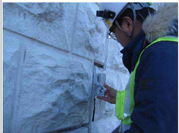
경사계를 이용한 경사도 측정
