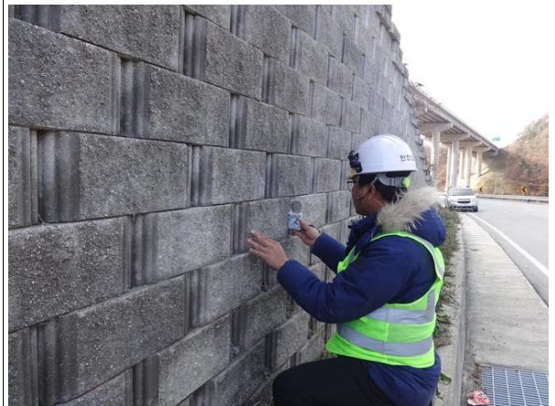
경사계를 이용한 경사도 측정
