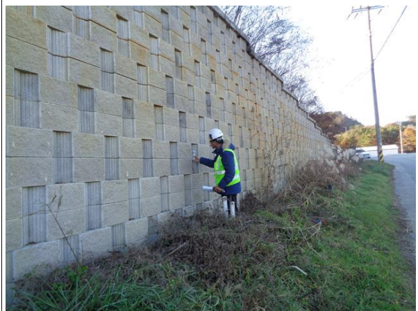
경사계를 이용한 경사도 측정
