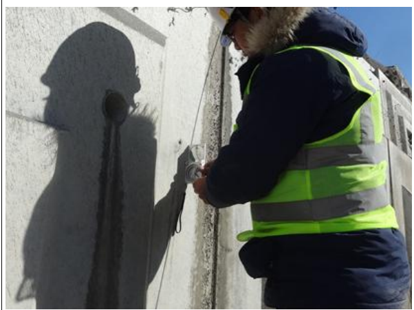
경사계를 이용한 경사도 측정
