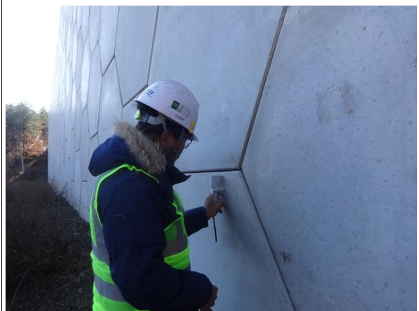
경사계를 이용한 경사도 측정
