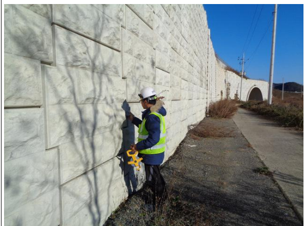
경사계를 이용한 경사도 측정
