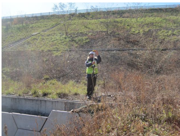
GPS측량기를 이용한 측량 작업
