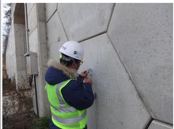
경사계를 이용한 경사도 측정
