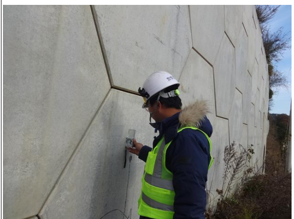
경사계를 이용한 경사도 측정
