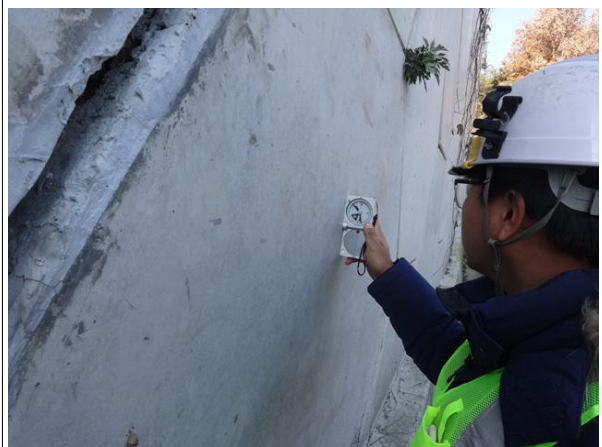
경사계를 이용한 경사도 측정
