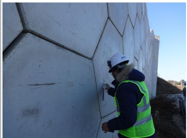
경사계를 이용한 경사도 측정
