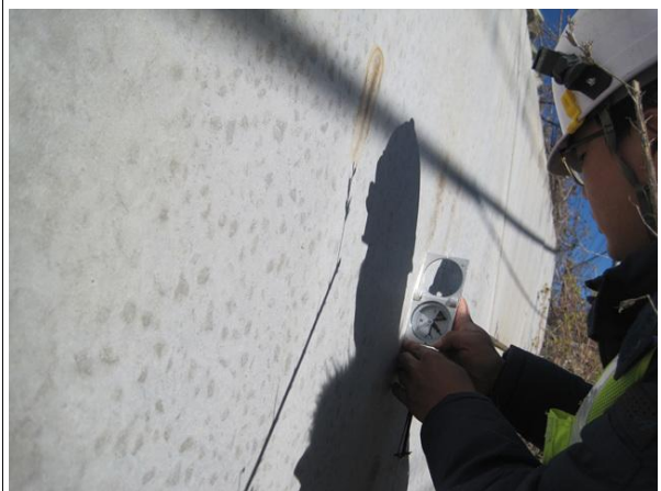
경사계를 이용한 경사도 측정
