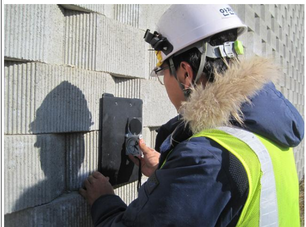
경사계를 이용한 경사도 측정
